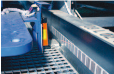
Positionnement d'appareils de contrôle de rayonnages pour les techniques de stockage et de convoyage
