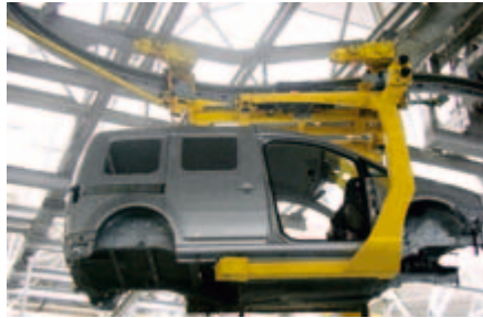
Positionnement de transporteurs aériens électriques pour l'industrie automobile
