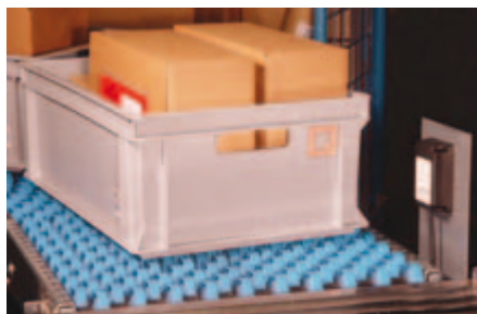
Identification de récipient pour la préparation de commande et le flux des marchandises
