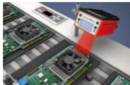
Code Data Matrix marqué au laser
